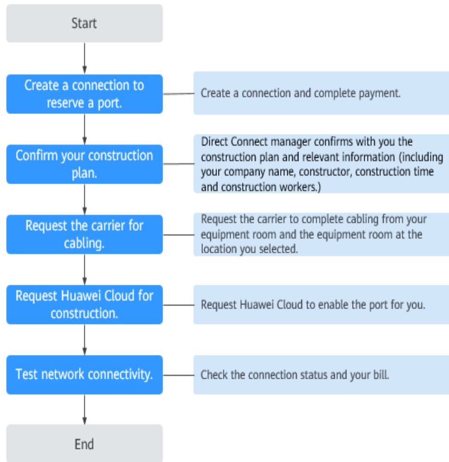
Figura 1-2 Proceso de instalación de autoservicio
